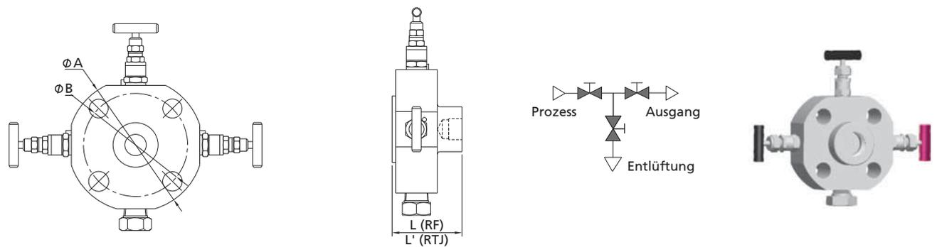
Primär: OS&Y Sekundär: Nadel Ablass: Nadel (Konfiguration: ONN, Absperrung/Absperrung/Ablass: X)
