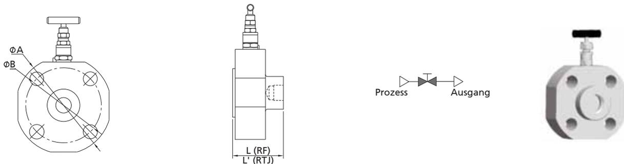
Abmessungen identisch mit einzelnen Monoflansch-Absperrventilen und -Ablussventilen
