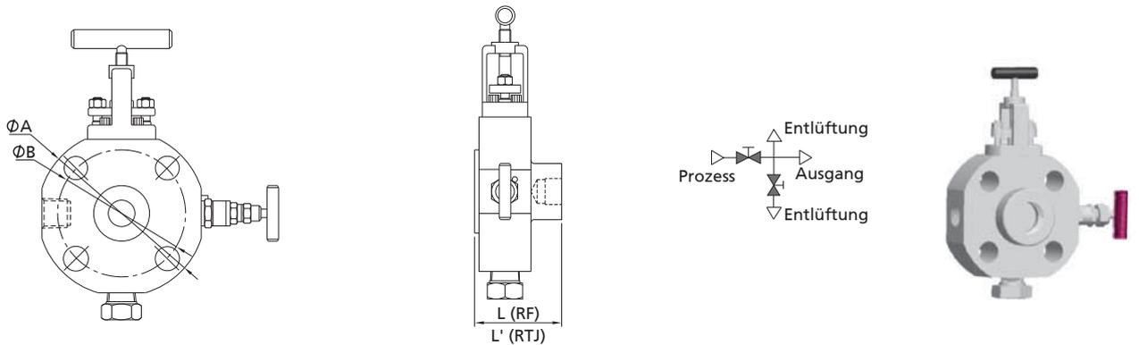
Absperr: Nadel    Ablass: Nadel    (Konfiguration: NN, zwei Entlüftungen)
