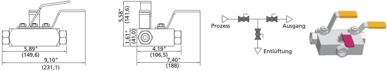
Primär: Kugel Sekundär: Kugel Ablass: Kugel (Konfiguration: BBB)
