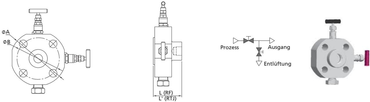
Absperr: OS&Y    Ablass: Nadel    (Konfiguration: ON, zwei Entlüftungen)
