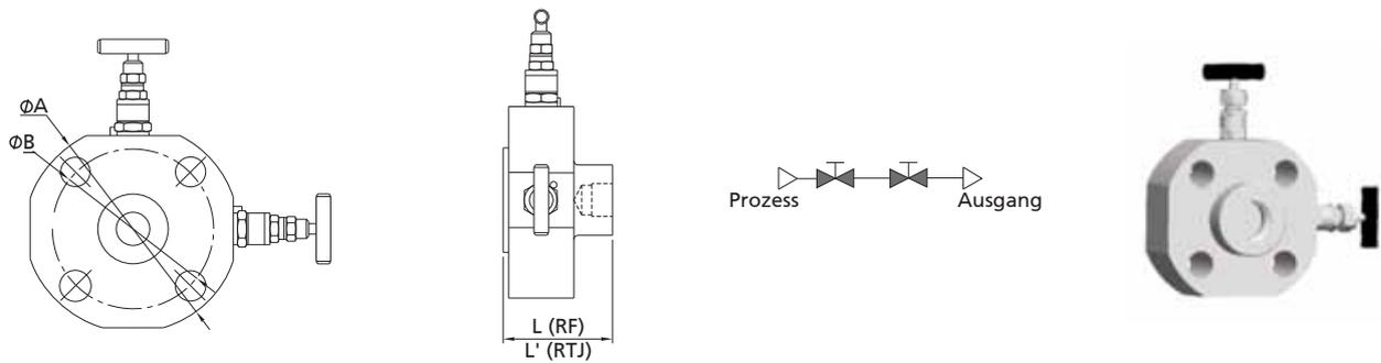
*Abmessungen identisch mit einzelnen Monoflansch-Absperrventilen und -Ablassventilen*
