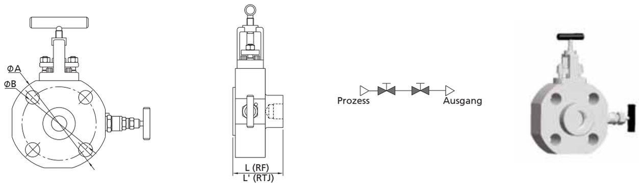
Primär: Nadel Sekundär: Nadel (Konfiguration: NN)
