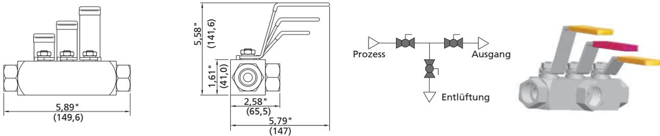
Primär: Nadel Sekundär: Nadel Ablass: Nadel (Konfiguration: NNN)
